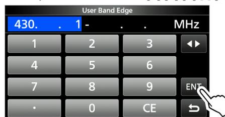
4. Inserire la frequenza del limite banda superiore, quindi toccare [ENT]. (Esempio: 439,9)
