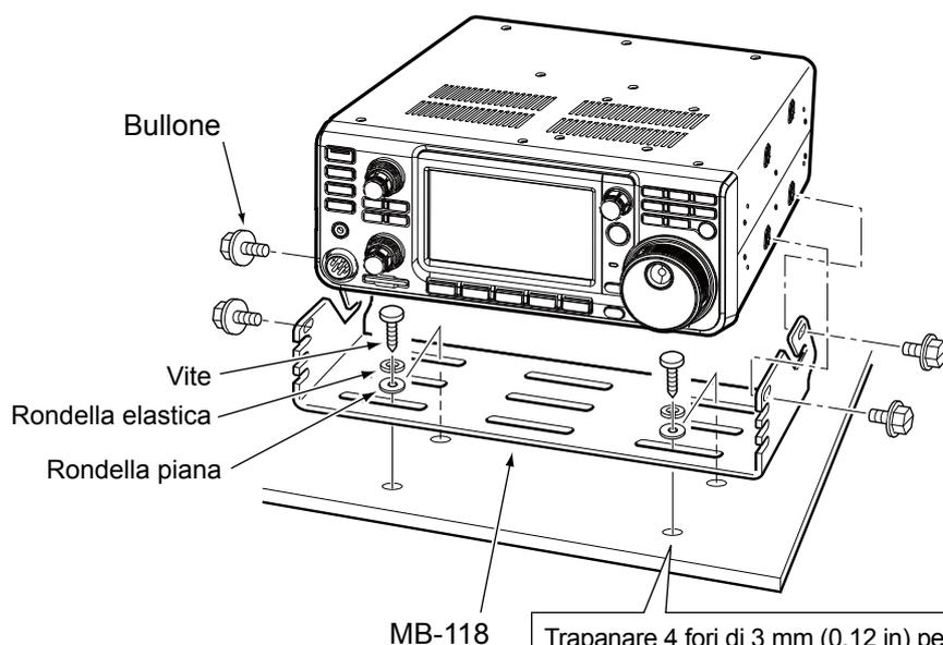
Trapanare 4 fori di 3 mm (0,12 in) per l'applicazione della staffa.
