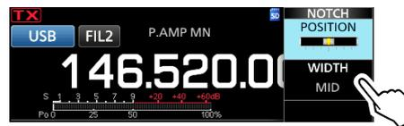
3. Ruotare **MULTI** lentamente, per attenuare manualmente la frequenza.
