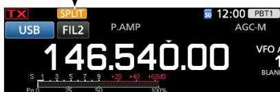
3. Mentre si tiene premuto **[XFC]**, impostare l'offset della frequenza di funzionamento tra trasmissione e ricezione.
