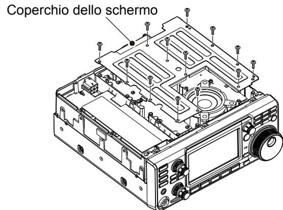
3. Sostituire il fusibile dei circuiti come indicato sotto.
