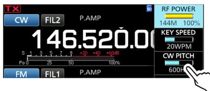
4. Impostare il passo CW su un valore tra 300 e 900 Hz (in passi di 5 Hz).
