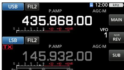
① Selezionare una frequenza libera all'interno della copertura del satellite. Monitorare la frequenza di funzionamento per assicurarsi che la trasmissione non causerà interferenze ad altre stazioni.
