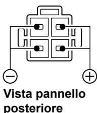
Accetta la corrente CC regolata per 13,8 V CC ±15% attraverso il cavo di alimentazione CC in dotazione.
