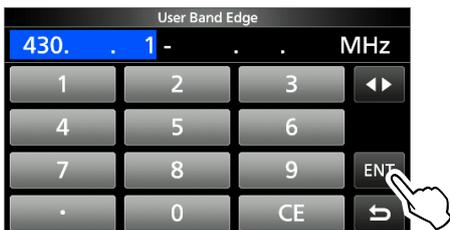
5. Inserire la frequenza del limite banda superiore, quindi toccare [ENT]. (Esempio: 439,9)
