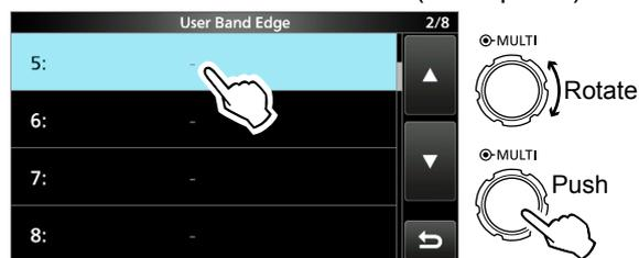
3. Inserire la frequenza del limite banda inferiore, quindi toccare [ENT]. (Esempio: 430,1)
