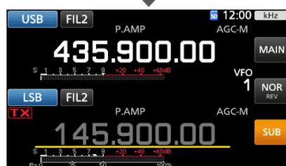
4. Ruotare **MAIN DIAL** per impostare la frequenza di uplink.
