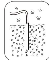
**⚠ AVVERTENZA! MAI** connettere il terminale [GND] a un tubo del gas o elettrico, poiché la connessione potrebbe causare un'esplosione o una scossa elettrica.
